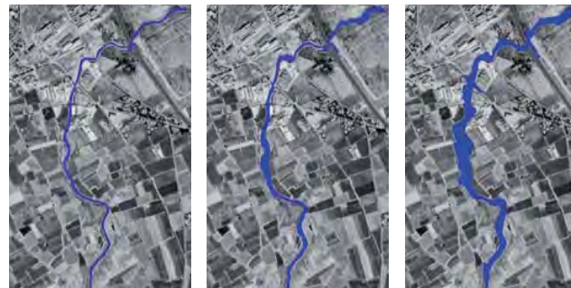
■ Zonas inundables obtenidas asociadas a los periodos de retorno de 25, 100 y 500 años
